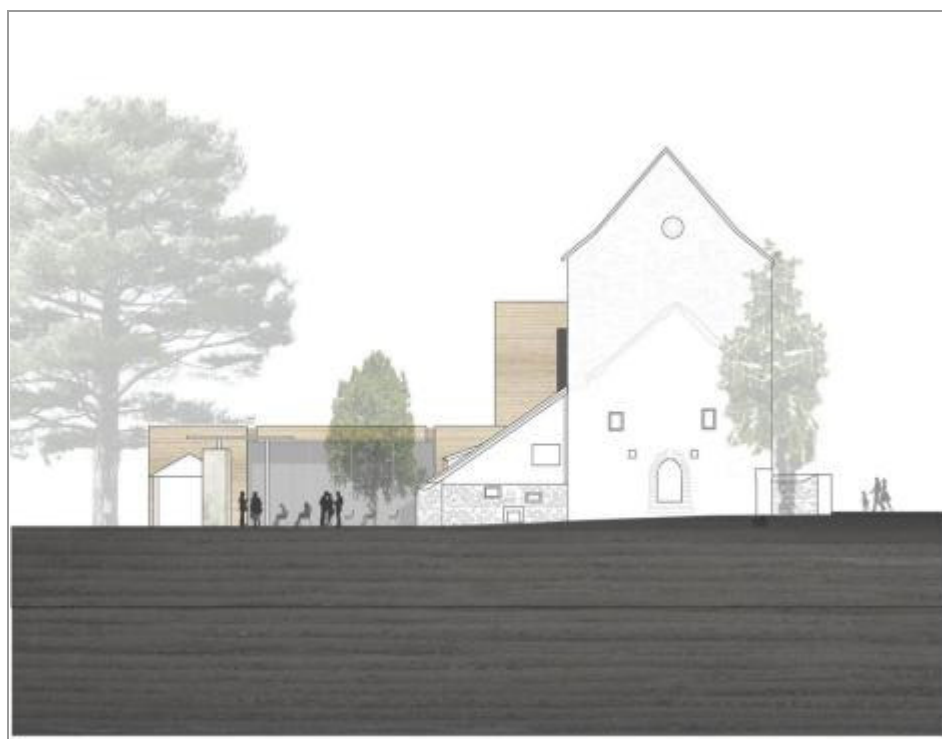
Baumaterial ist Sichtbeton, der so eingefärbt wird, dass er sich der Naturstein-Struktur der Klosterkirche anpasst. Hier die Ansicht von Westen. GRAFIKEN: BÜRO BAMBERG
